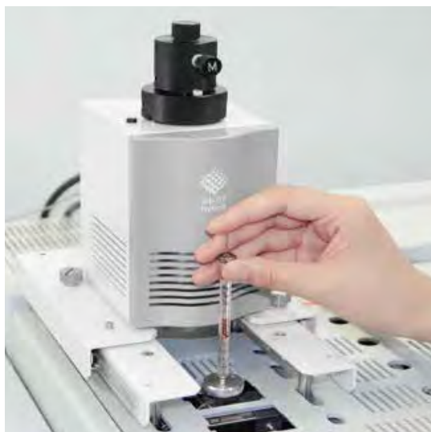
将裂解炉设置于进样口后方，保证 GC 的正常分析需要。
